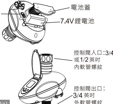
將水管連接控制閥入口與水龍頭之間，將控制閥入口直立並順時鐘方向旋緊，以防止漏水。從控制閥出口連接水管可用於澆花灑水等用途，或連結到排汙閥的水淨化處理設備。
