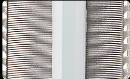
外置兩根膠條，膠條和濾瓶內壁產生摩擦，從而清除殘留在內壁上的雜質。
