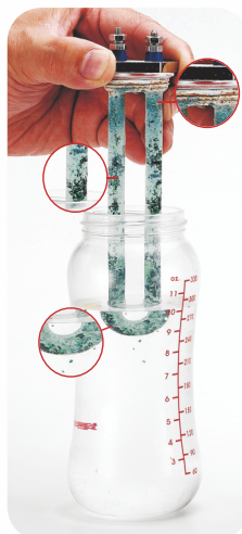
傳統不銹鋼加熱管 (使用壽命1-2年)
